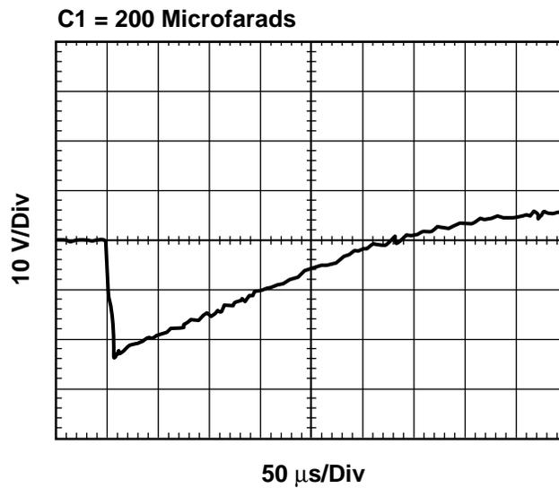
Figure 4-13(d). Turn-on transient test data (200  $\mu$ F).
